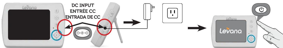
**3** Connecting the camera / Connexion de la caméra / Conexión de la cámara
