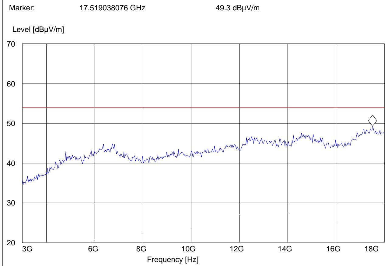
**EMISSION LIMITATIONS - Radiated (Transmitter) §15.247 (d) & RSS-210(A8.5)**
