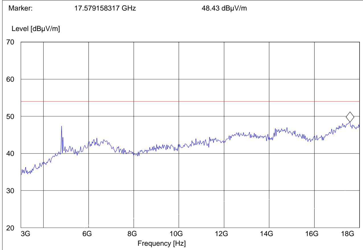
**EMISSION LIMITATIONS - Radiated (Transmitter) §15.247 (d) & RSS-210(A8.5)
