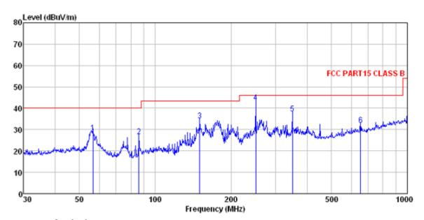
Site : 3m chamber Condition : FCC PART15 C
