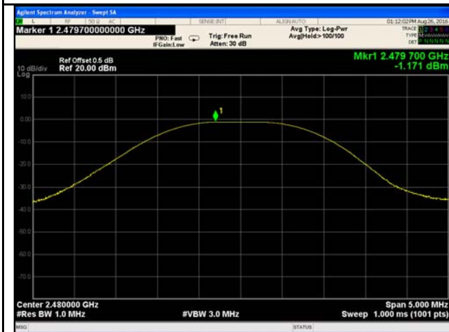
AV Output power - High CH 2480
