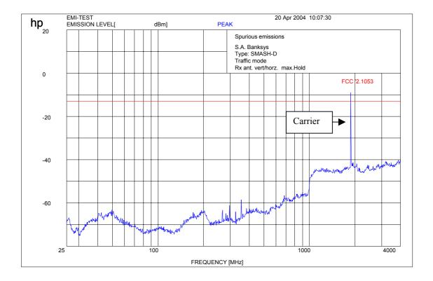
f < 1 GHz : RBW/VBW : 100 kHz  $f \ge 1 \text{GHz} : \text{RBW / VBW 1 MHz}$
