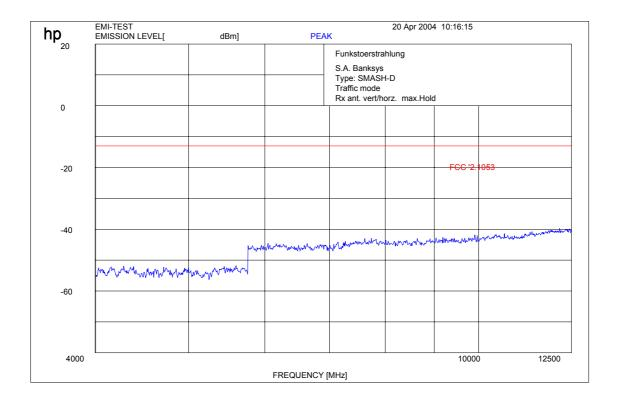
f < 1 GHz : RBW/VBW : 100 kHz  $f \ge 1 \text{GHz} : \text{RBW/VBW} 1 \text{ MHz}$
