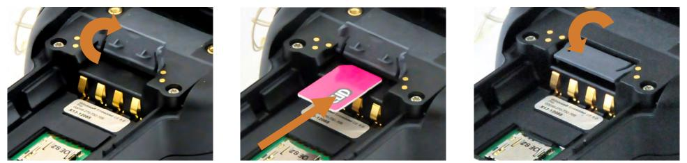
INSTALLING THE MICRO SD CARD
