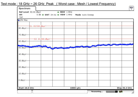
Note 1 : Measured distance : 1 m Note 2 : Limit : Peak : 83.5 dBµV/m Average : 63.5 dBµV/m
