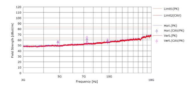
Note 1 : Measured distance : 1 m Note 2 : Limit : Peak : 83.5 dBµV/m Average : 63.5 dBµV/m
