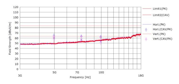
Note 1 : Measured distance : 1 m Note 2 : Limit : Peak : 83.5 dB $\mu$ V/m Average : 63.5 dB $\mu$ V/m
