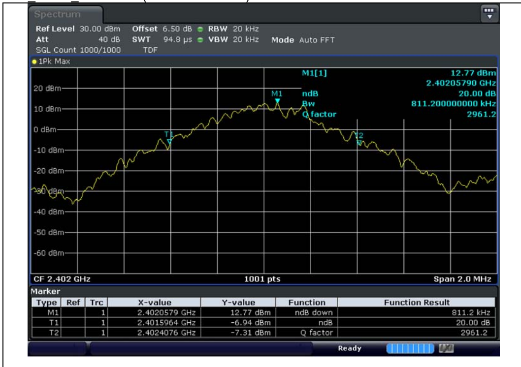
M1_GFSK_2_402_MHz(20 dB Bandwidth)
