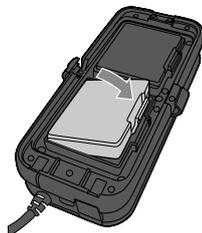
Le voyant de batterie s'éclaire en vert avant l'arrêt. Si le voyant de batterie de l'autre batterie clignote en rouge, répétez la procédure pour remplacer cette batterie. Lorsque les deux voyants de batterie s'éteignent, le remplacement de la batterie est terminé.
