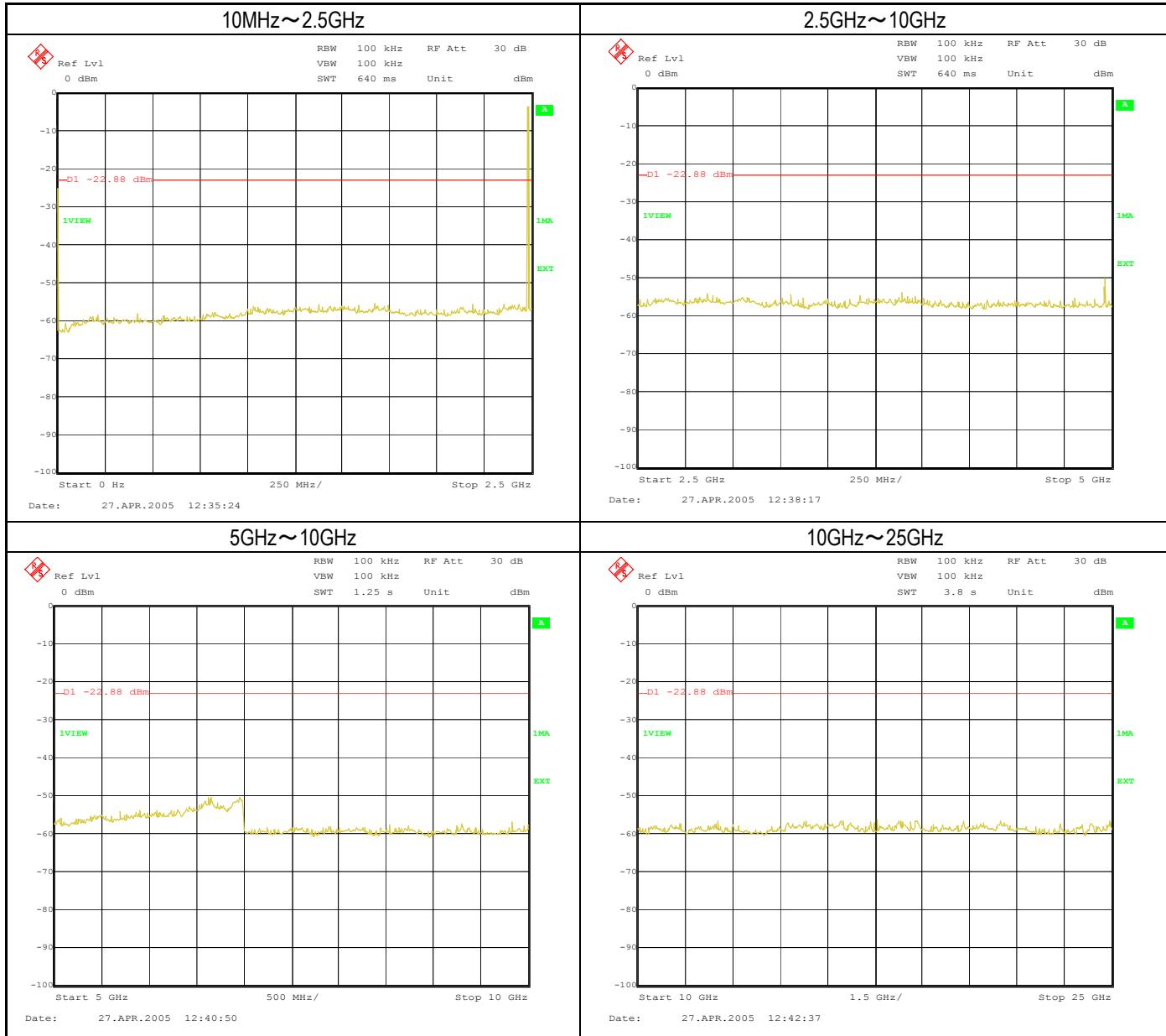
(2) Operation mode: Transmitting mode , ( $\pi/4$  DQPSK Modulation)
