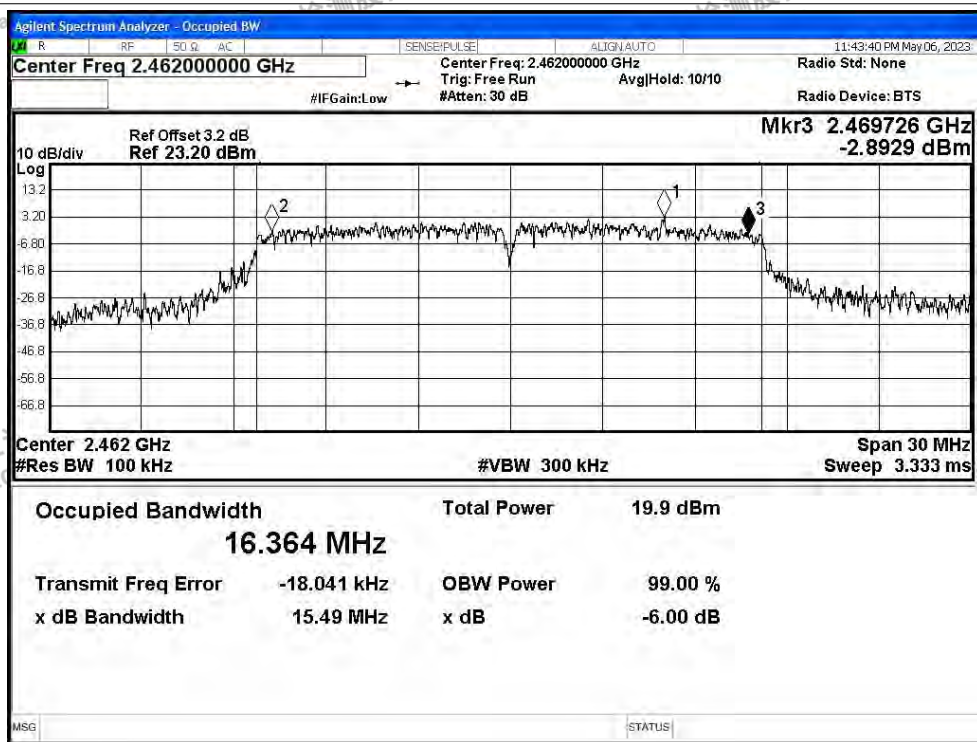
-6dB Bandwidth NVNT g 2462MHz Ant1
