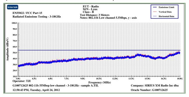
$Lynx\ B\ -\ Peak\ Plot-3000MHz-18000MHz-802.11b-5.5Mbps-Low\ Channel$
