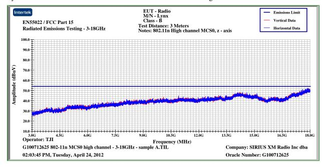
$Lynx\ B\ -\ Peak\ Plot\ -\ 3000MHz\ -\ 18000MHz\ -\ 802.11n\ -\ MCS0\ -\ High\ Channel$
