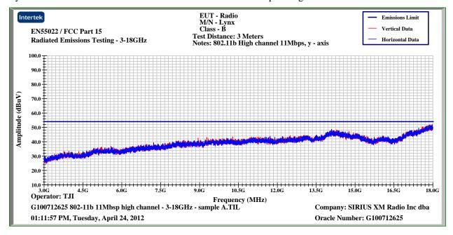
$Lynx\ B\ -\ Peak\ Plot-3000MHz-18000MHz-802.11b-11Mbps-High\ Channel$
