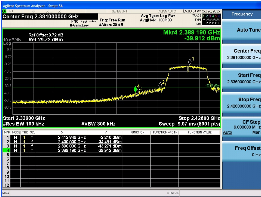
(Plot 4.5.2.2 A: Channel 01: 2412MHz @ 802.11 g)
