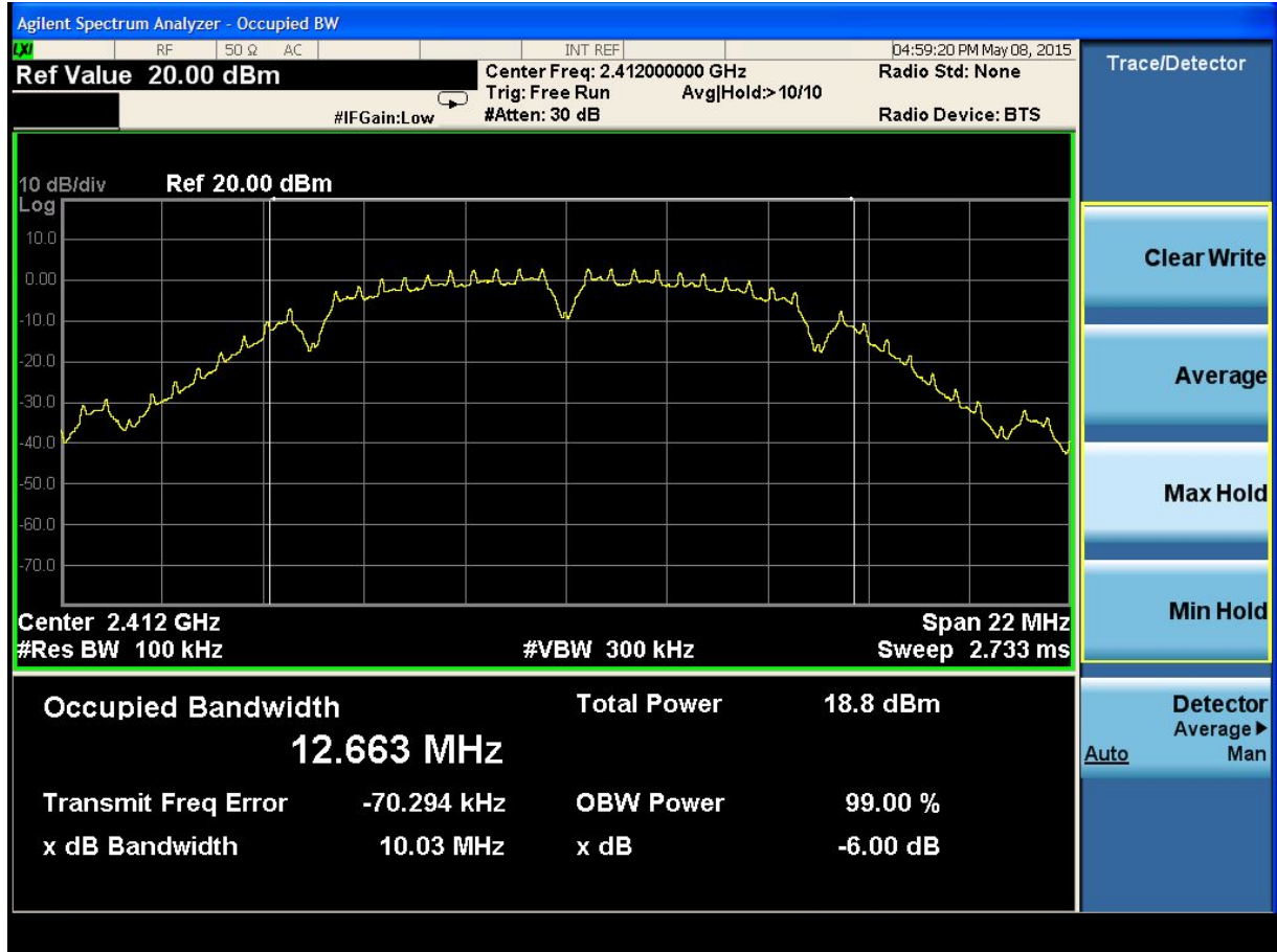
(Plot 4.7.1 A: Channel 1: 2412MHz @ 802.11b)
