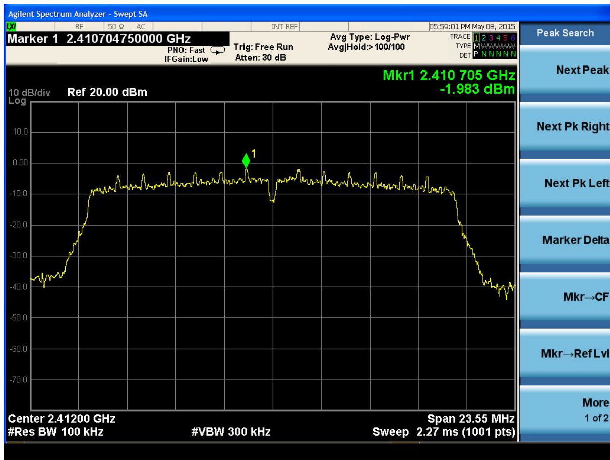
(Plot 4.4.3 A: Channel 1: 2412MHz @ 802.11n HT20)
