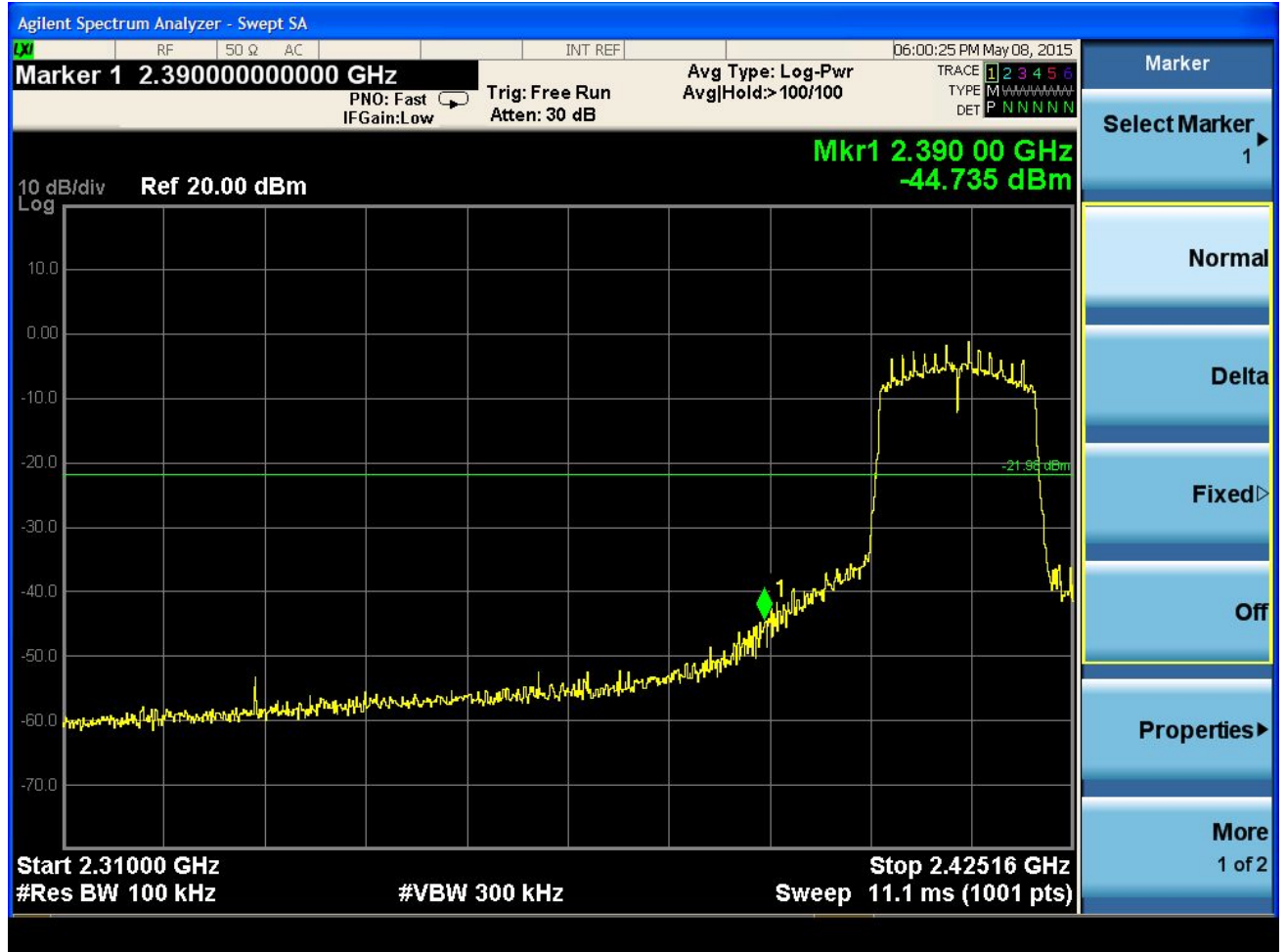
Plot 4.5.2.3 A: Channel 01: 2412MHz @ 802.11n HT20)
