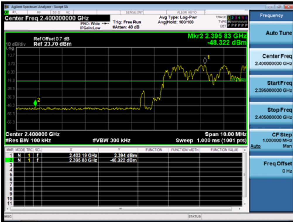
(Plot 4.5.2.3 B: Hopping Mode @ \pi/4 DQPSK)
