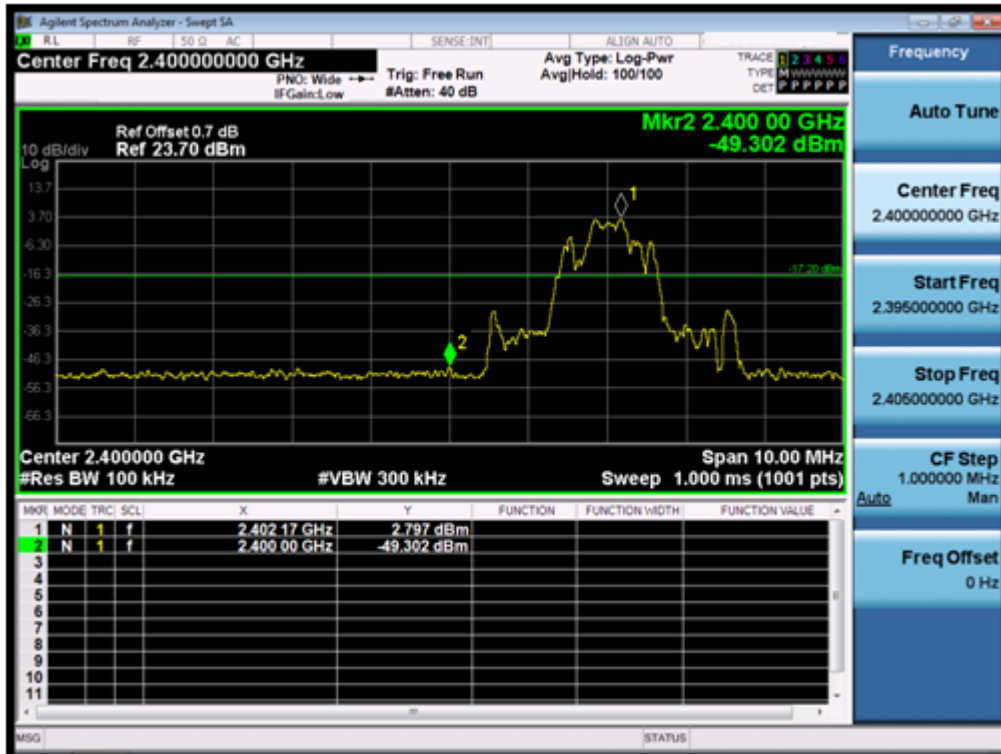
(Plot 4.5.2.3 A: Channel 00: 2402MHz @ \pi/4 DQPSK)
