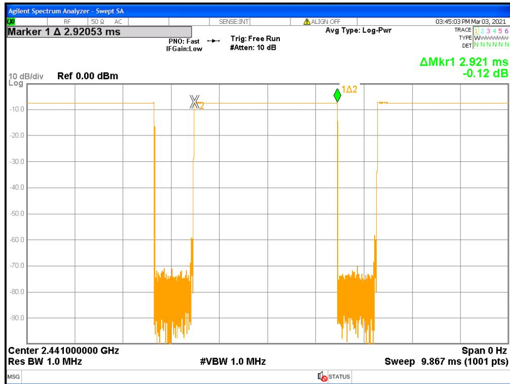
$\pi/4$ -DQPSK (2Mbps) Rate: 2DH5 Channel: 78
