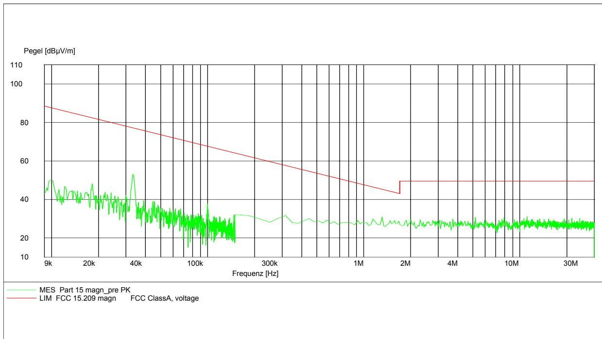
**f < 1 GHz : RBW/VBW: 100 kHz      f ≥ 1GHz : RBW/VBW 1 MHz**
