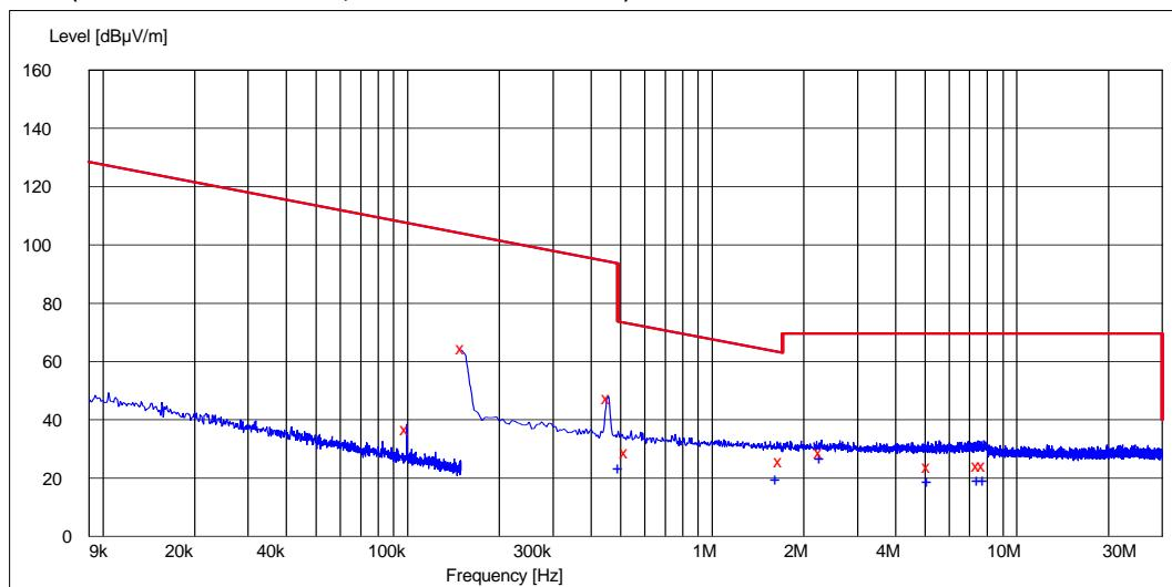
QuasiPeak (<150kHz: RBW: 200Hz, >150kHz: RBW: 9kHz)
