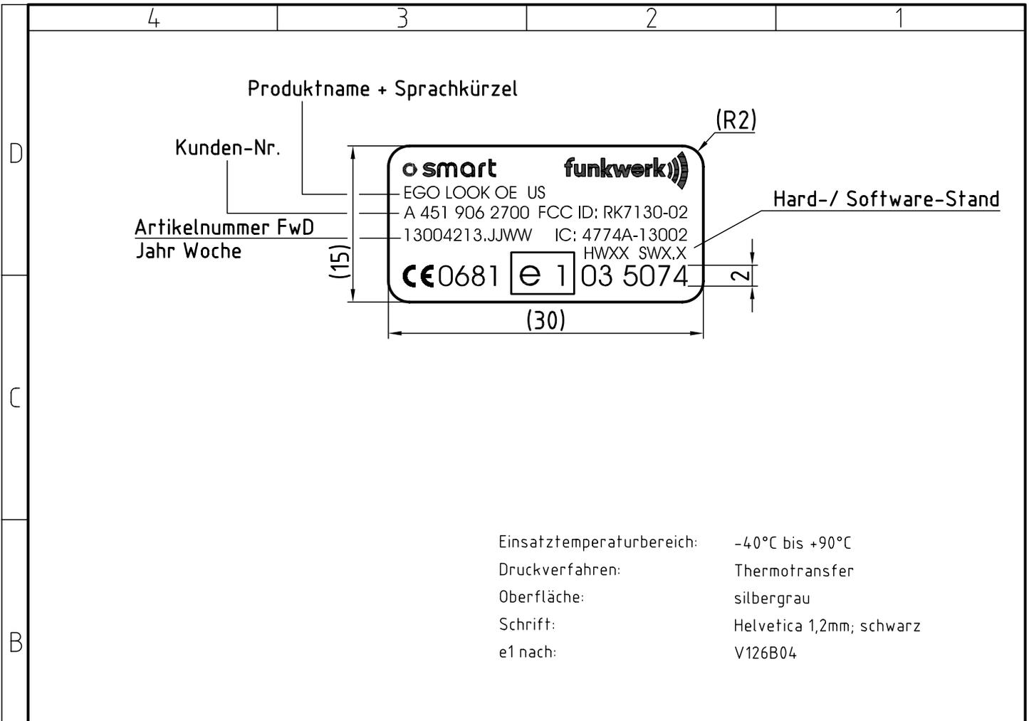
Einsatztemperaturbereich: -40°C bis +90°C
