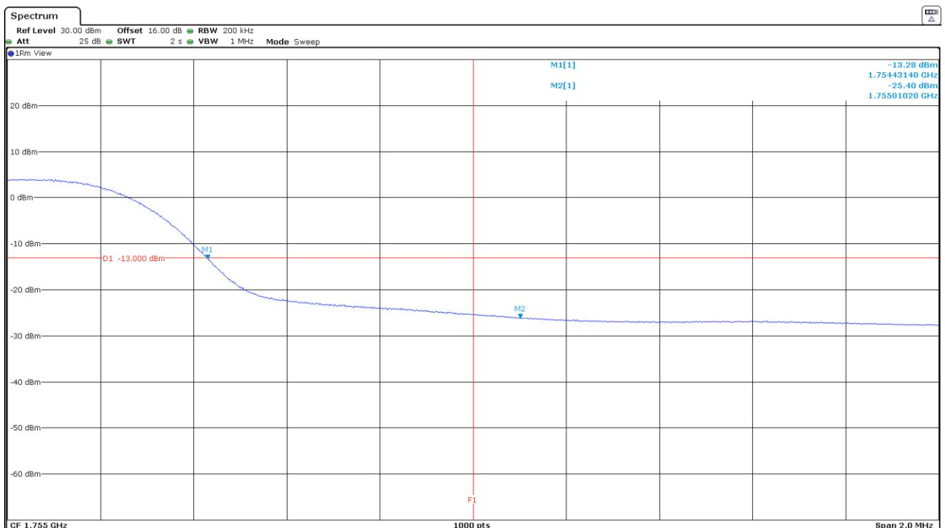
LTE Band 4. QPSK MODULATION. BW=20 MHz. RB=1. Offset=Max. High Block Edge:
