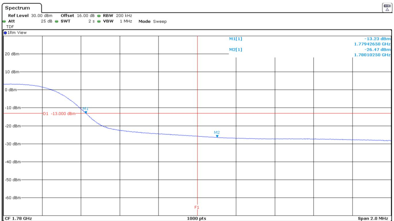
LTE Band 66. QPSK MODULATION. BW=20 MHz. RB=1. Offset=0. Low Block Edge:
