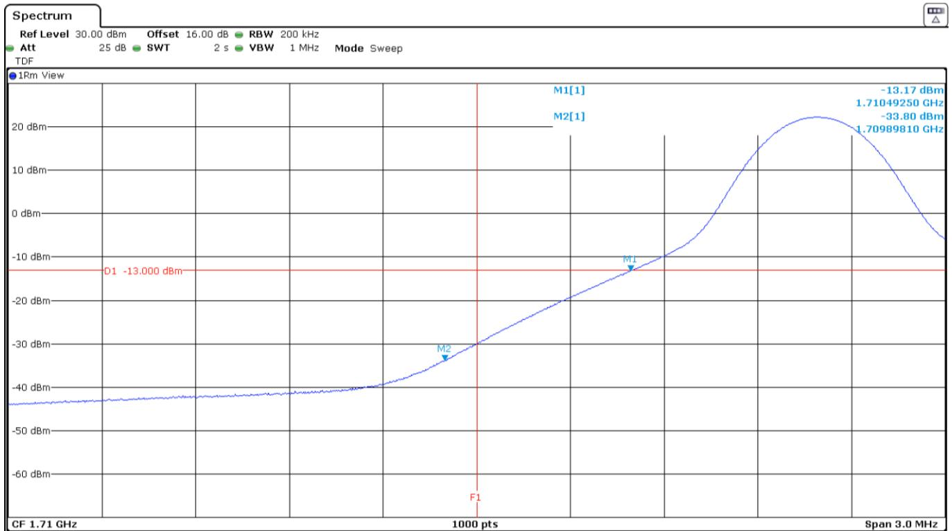
LTE Band 66. QPSK MODULATION. BW=20 MHz. RB=1. Offset=Max. High Block Edge:
