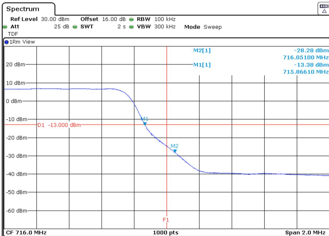
LTE Band 12. QPSK MODULATION. BW=10 MHz. RB=1. Offset=0. Low Block Edge:
