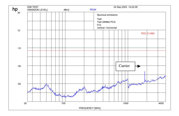
f < 1 GHz : RBW/VBW: 100 kHz  $f \ge 1 \text{GHz} : \text{RBW} / \text{VBW} 1 \text{ MHz}$
