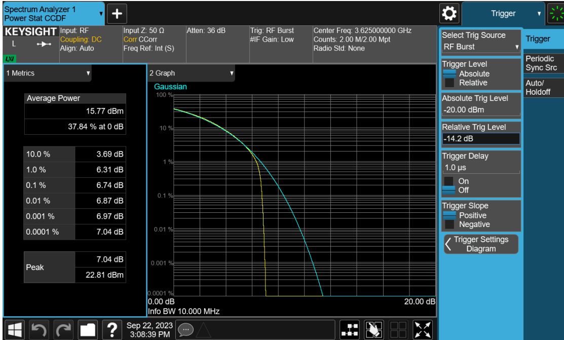
Plot 7-57. PAR Plot (NR Band n78 - 10MHz CP-OFDM QPSK– Full RB)
