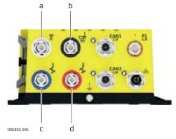
a) White: Radiob) Black: Modemc) Blue: GNSS Antenna 1d) Red: GNSS Antenna 2
