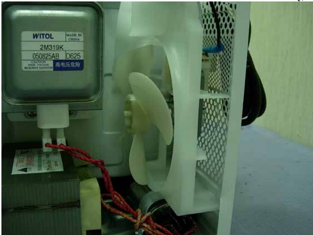
Photo 35 M/N: TSK-M3204MEQ, Fan Motor
