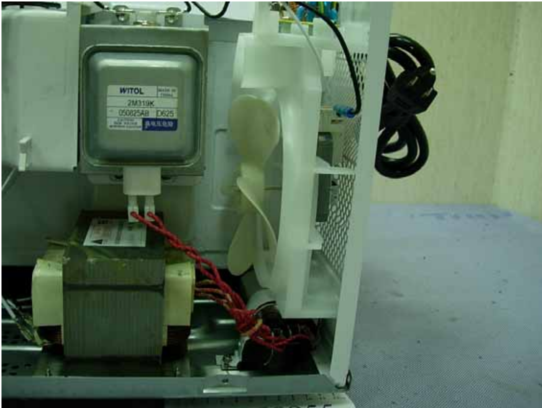
Photo 19 M/N: TSK-M3204ME, Fan Motor
