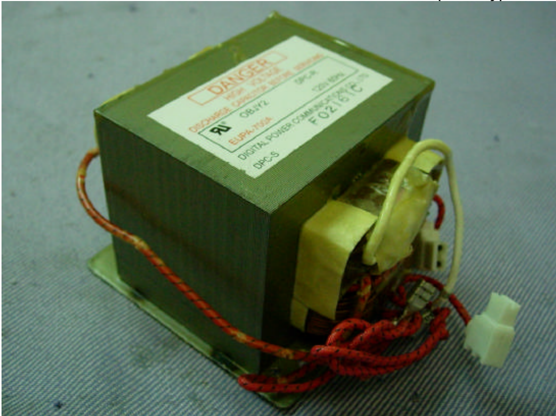
Photo 45 H.V. Transformer (DPC Type EUPA-700A)
