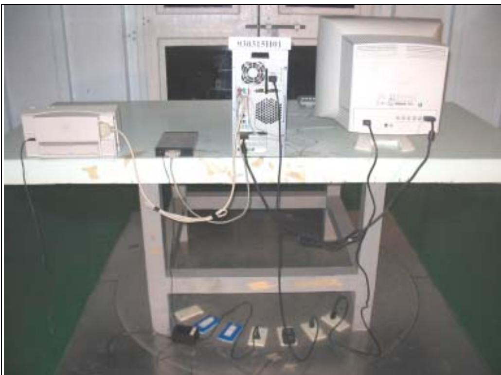
**RADIATED EMISSION TEST-ANTENNA 2**
