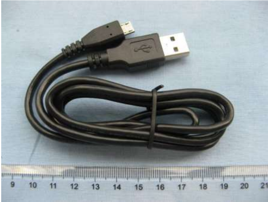
Data Cable AE16
