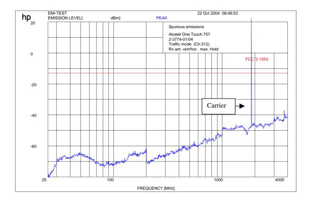
$f < 1 \; GHz : RBW/VBW : 100 \; kHz \\ \hspace*{1.5cm} f \geq 1GHz : RBW \; / \; VBW \; 1 \; MHz$
