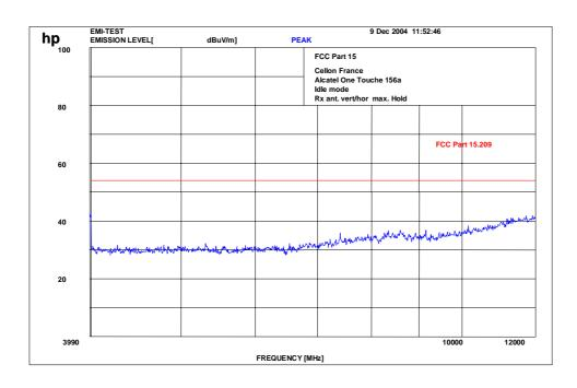
f < 1 GHz: RBW/VBW: 100 kHz  $f \ge 1 \text{GHz}$ : RBW/VBW 1 MHz
