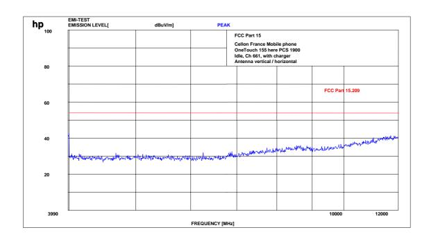
f < 1 GHz: RBW/VBW: 100 kHz  $f \ge 1 \text{GHz}$ : RBW/VBW 1 MHz
