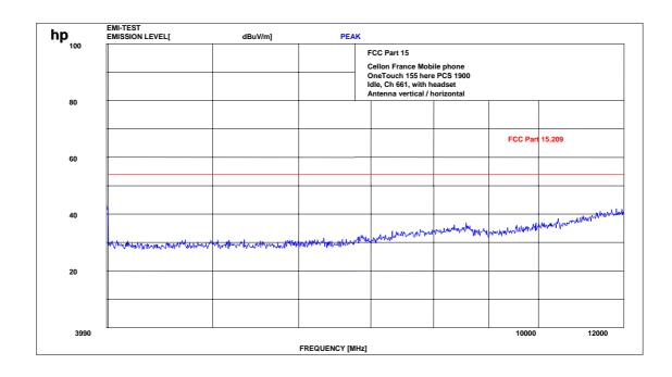
$f < 1 \; GHz : RBW/VBW : 100 \; kHz$   $f \ge 1 \; GHz : RBW/VBW \; 1 \; MHz$
