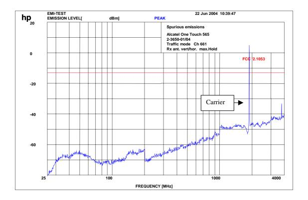
f < 1 GHz: RBW/VBW: 100 kHz  $f \ge 1GHz: RBW/VBW: 1 MHz$
