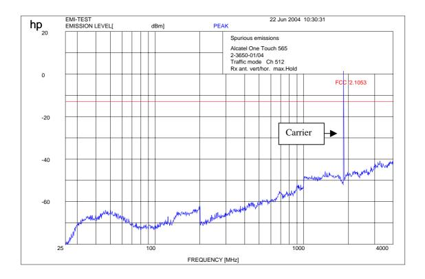
f < 1 GHz: RBW/VBW: 100 kHz  $f \ge 1GHz: RBW/VBW: 1 MHz$
