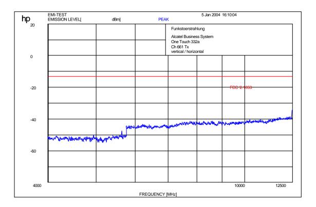
f < 1 GHz : RBW/VBW : 100 kHz f? 1GHz : RBW/VBW 1 MHz
