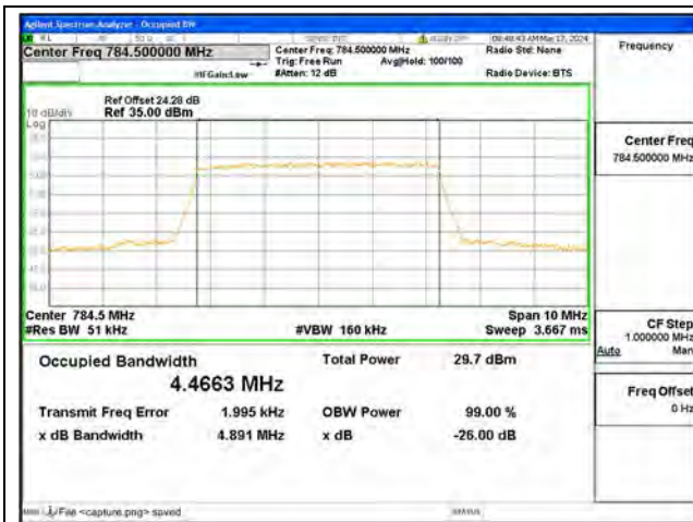
B13 / 5MHz / QPSK/ High CH
