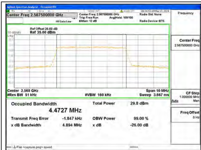
B7 / 5MHz / QPSK/ High CH
