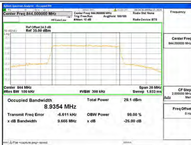
B5 / 10MHz / 64QAM/ High CH
