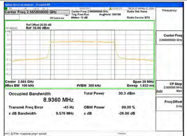
B7 / 10MHz / QPSK/ High CH
