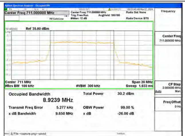
B17 / 10MHz / QPSK/ High CH
