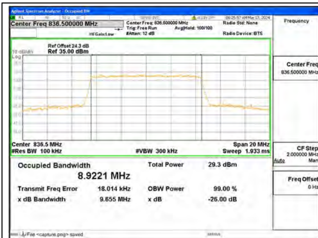
B5 / 10MHz / 16QAM/ Mid CH
