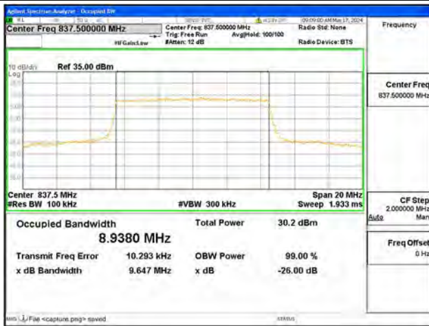
B19 / 10MHz / QPSK/ Mid CH
