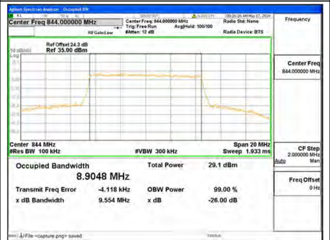
B5 / 10MHz / 16QAM/ High CH
