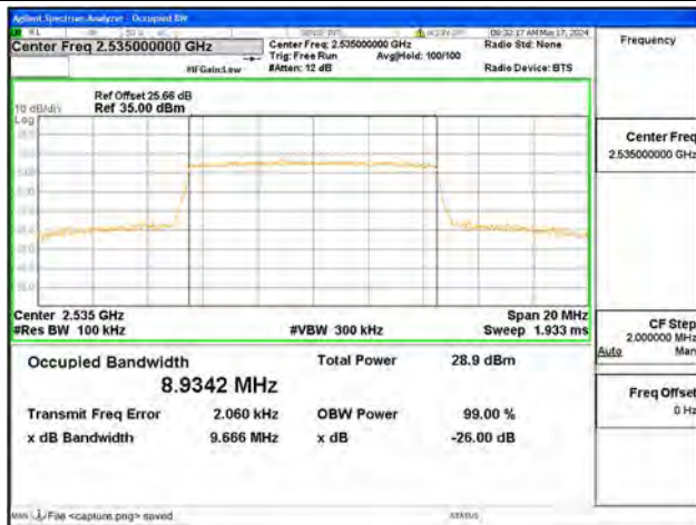
B7 / 10MHz / 64QAM/ Mid CH
