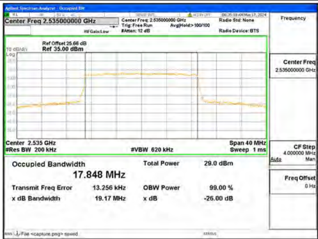
B7 / 20MHz / 64QAM/ Mid CH
