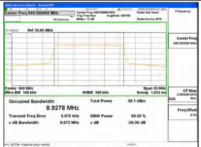
B19 / 10MHz / QPSK/ High CH
