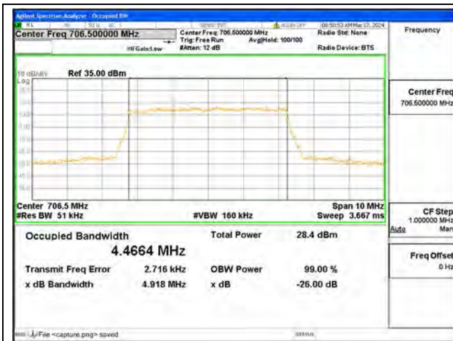
B17 / 5MHz / 16QAM/ Low CH
