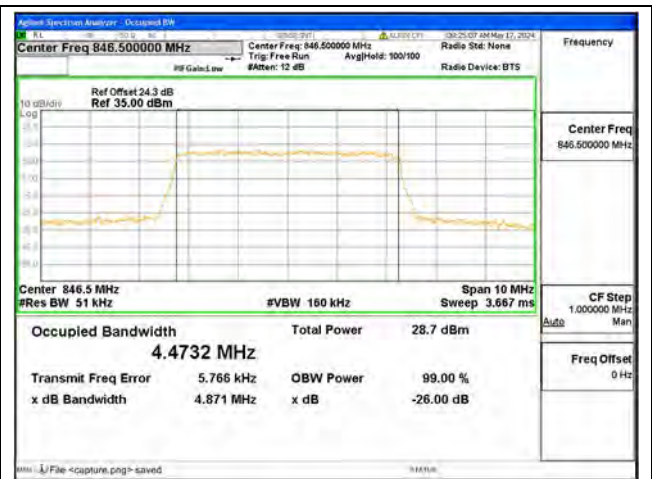
B5 / 5MHz / 64QAM/ High CH
