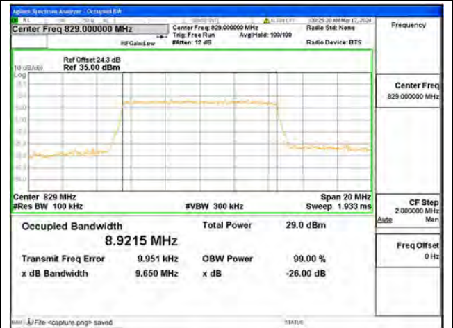
B5 / 10MHz / 16QAM/ Low CH
