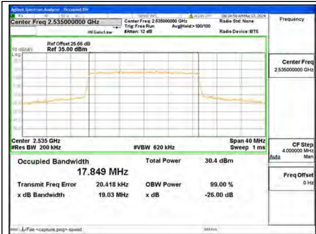
B7 / 20MHz / QPSK/ Mid CH
