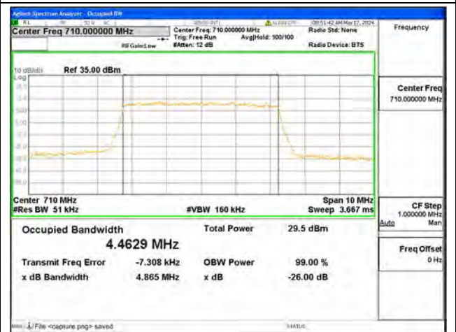
B17 / 5MHz / QPSK/ Mid CH
