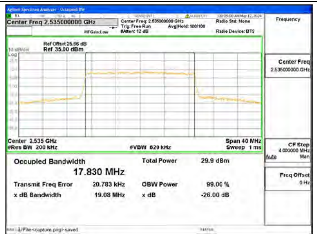
B7 / 20MHz / 16QAM/ Mid CH
