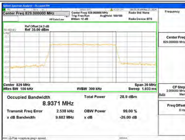
B5 / 10MHz / 64QAM/ Low CH
