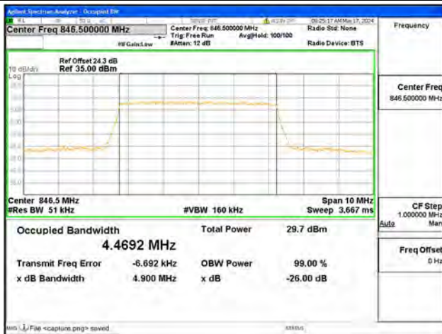
B5 / 5MHz / QPSK/ High CH
