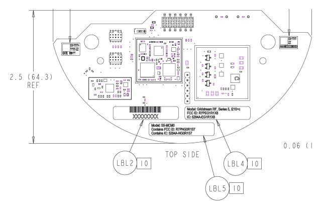
Figure 7. I210+c module FCC/IC labels
