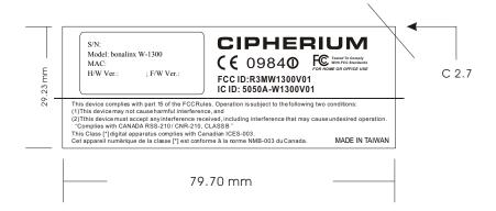
材質: 反銀龍#75**打字膜** 671001173300 LABEL FREQUENCY 79.7\*29.23mm (bonalinx W-1300)(CIPHERIUM)V1.0
