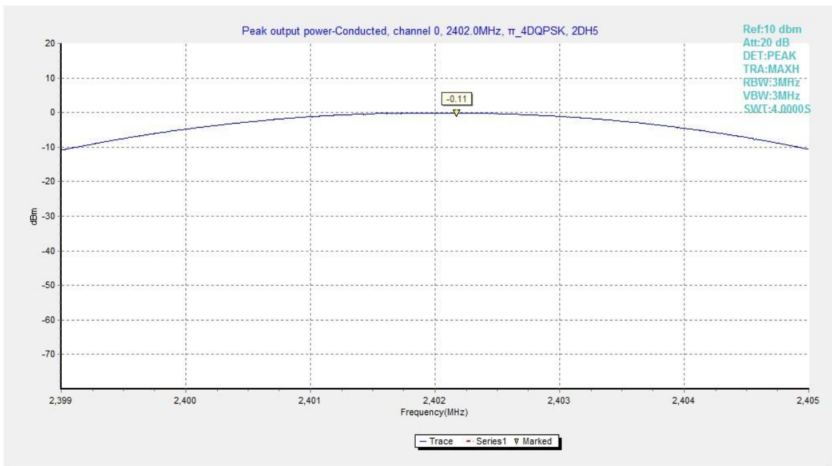
Fig. 4 RF output power ( \pi/4 DQPSK, Ch 0)
