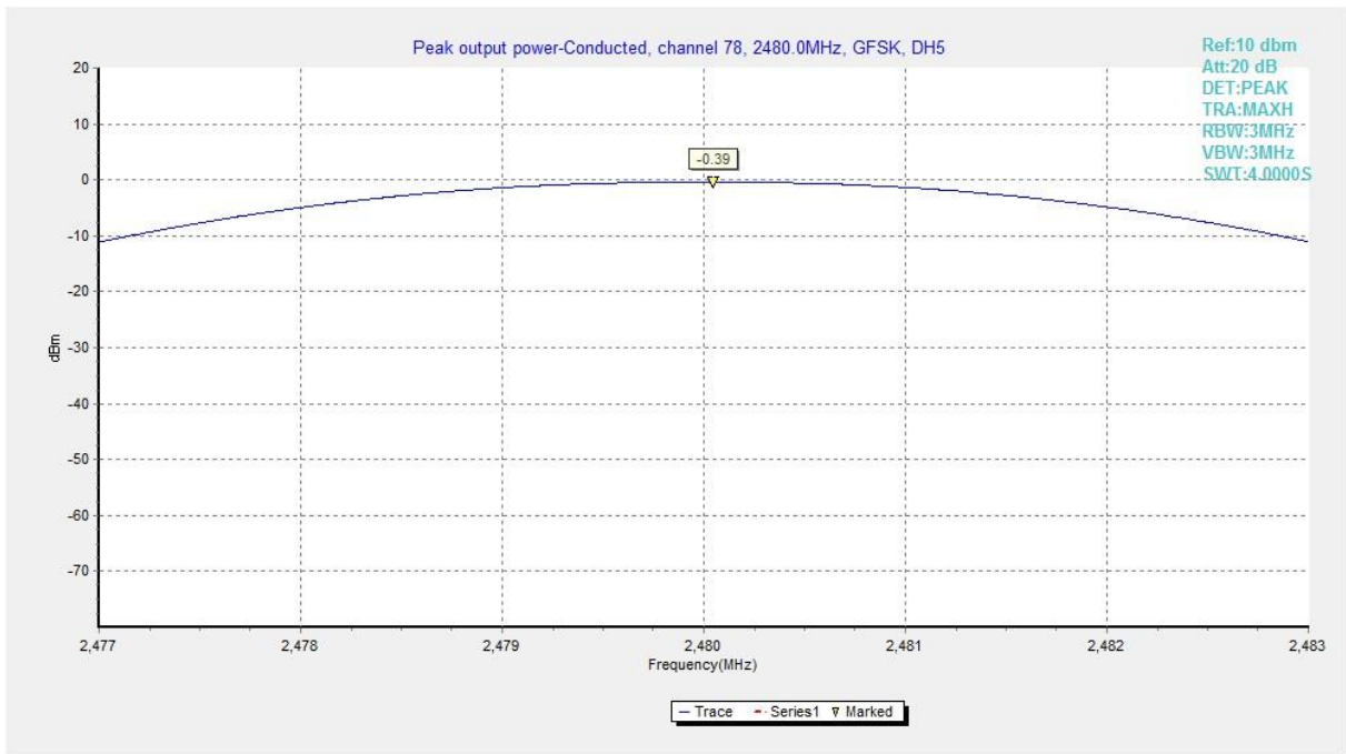
Fig. 3 RF output power (GFSK, Ch 78)
