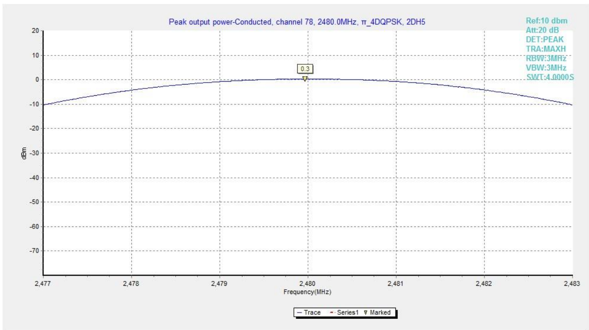
Fig. 6 RF output power ( \pi/4 DQPSK, Ch 78)
