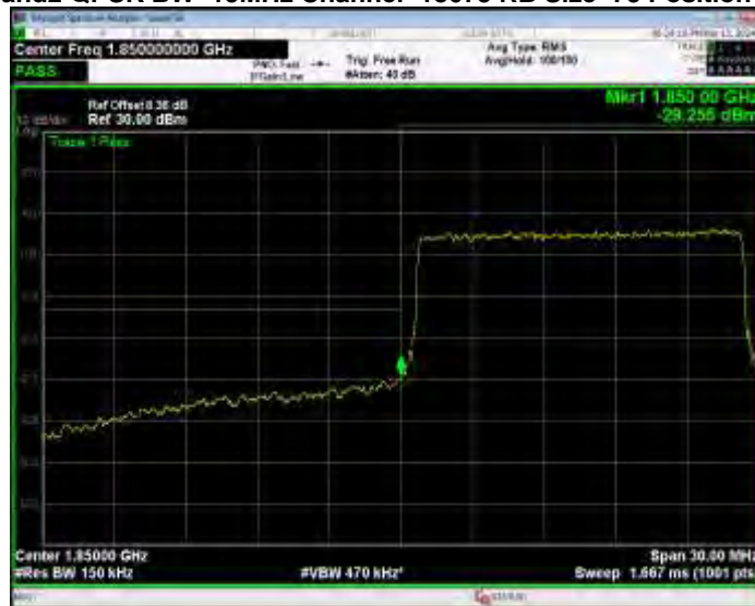
Band2 QPSK BW=15MHz Channel=19125 RB Size=1 Position=#0
