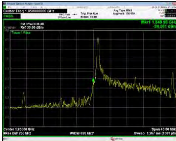
Band2 16QAM BW=20MHz Channel=18700 RB Size=100 Position=#0
