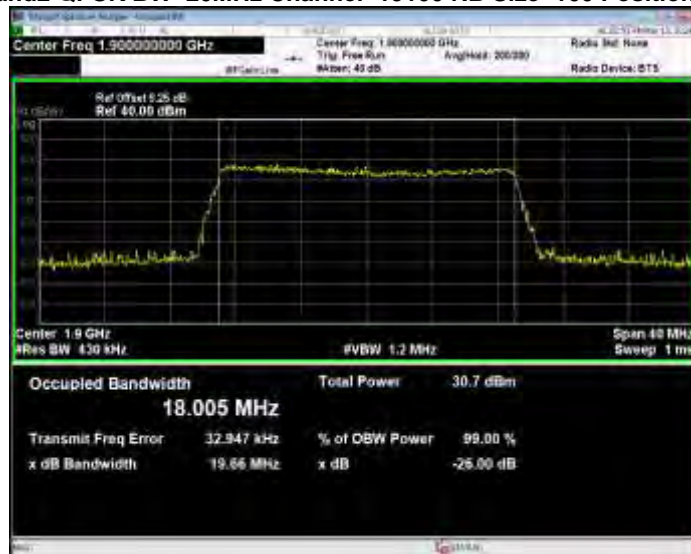
Band2 QPSK BW=20MHz Channel=19100 RB Size=100 Position=#0
