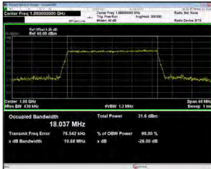
Band2 QPSK BW=20MHz Channel=19100 RB Size=100 Position=#0
