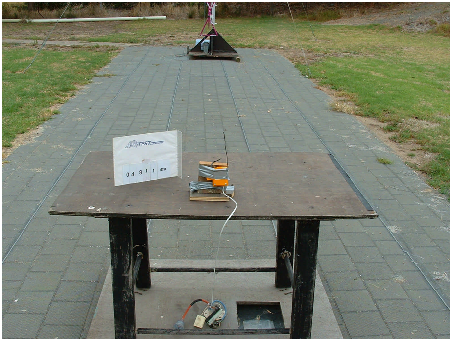
Photo 4: EUT OATS test (Rx)
