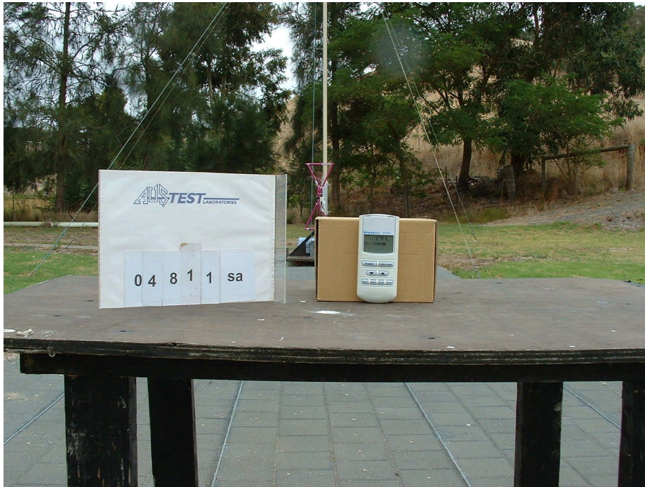
Photo 4: EUT OATS test (Rx)
