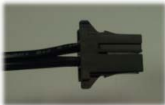
E1 Modem Power Terminal
