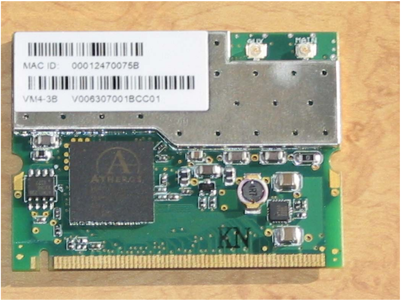
IEEE802.11 mini PCI module, covering removed
