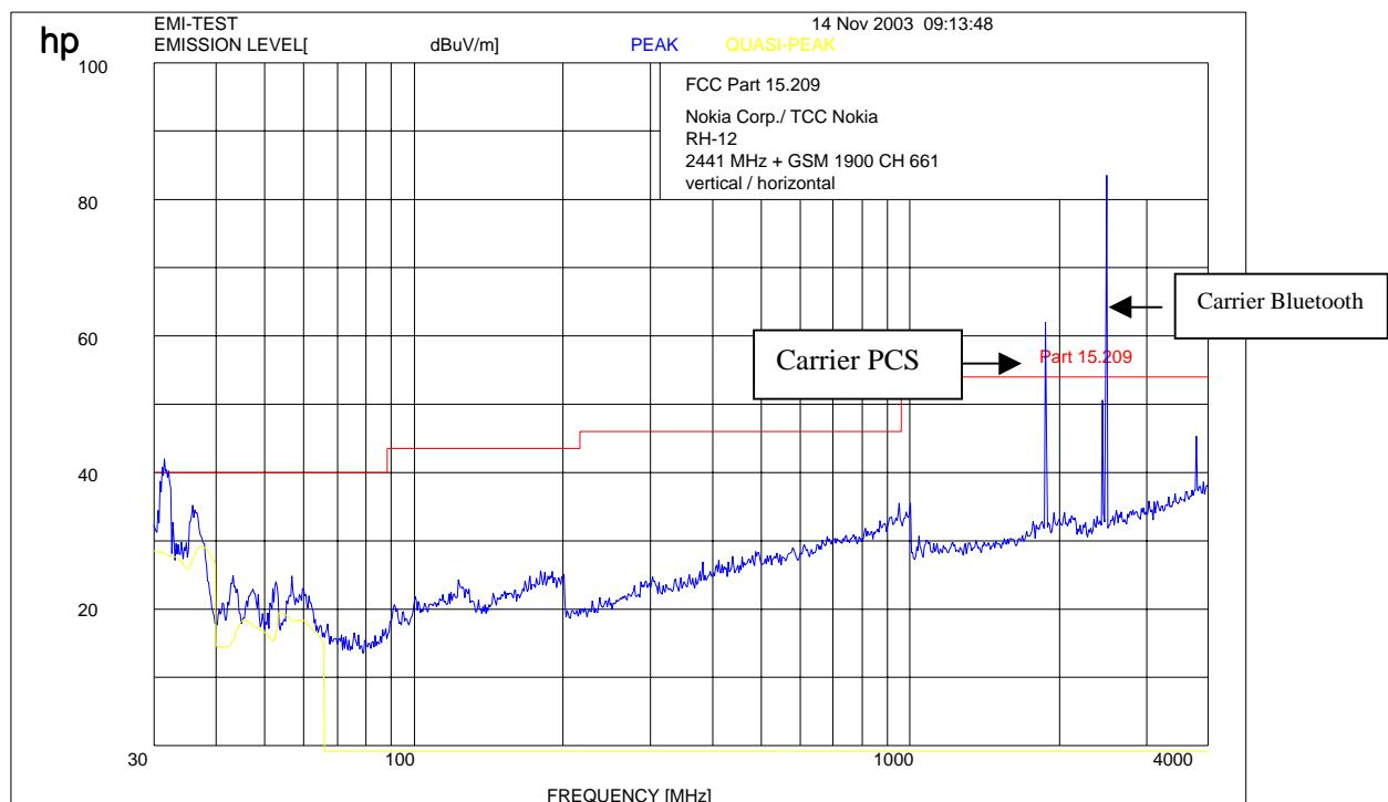
$f < 1 \text{ GHz}$  : RBW/VBW: 100 kHz       $f \geq 1 \text{ GHz}$  : RBW/VBW 1 MHz
