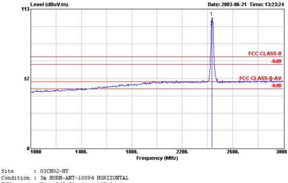
Condition : 3m HORN-ANT-10094 HORIZONTAL EUT : Mini PCI Wireless LAN Card Power : 110V/60Hz MODEL : 73-TMWBB-001 MEMO : TX CH06 2437MHz : F360603
