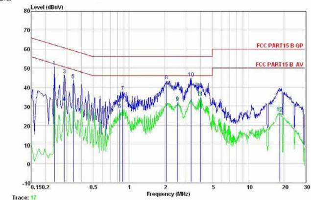
: CCIS Conducted Test Site : FCC PART15 B QP LISM LINE : 204RF Site Condition
