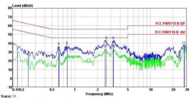
: CCIS Conducted Test Site : FCC PART15 B QP LISN LINE Site Condition : 441RF
