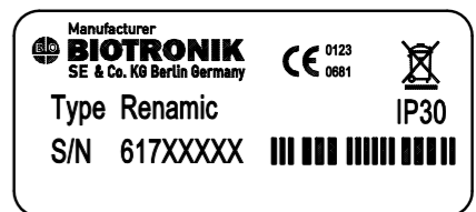
Detail X 1:1 Bedruckung Biotronik-Typenschild
