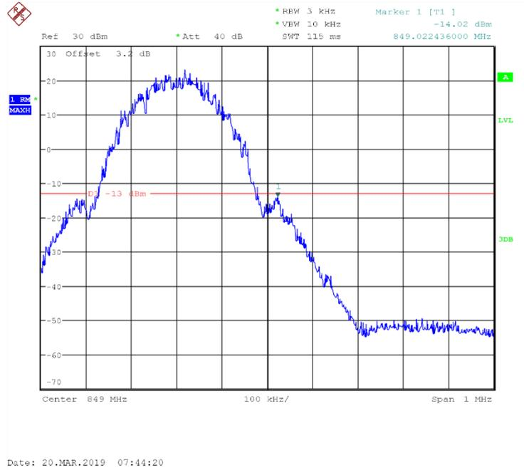
Fig.50 Channel 251- LOW BAND EDGE BLOCK
