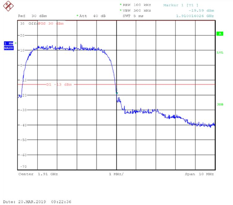
Fig.62 Channel 9538- LOW BAND EDGE BLOCK
