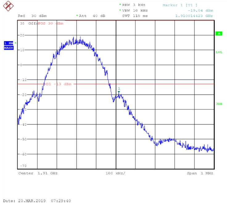
Fig.58 Channel 810- LOW BAND EDGE BLOCK
