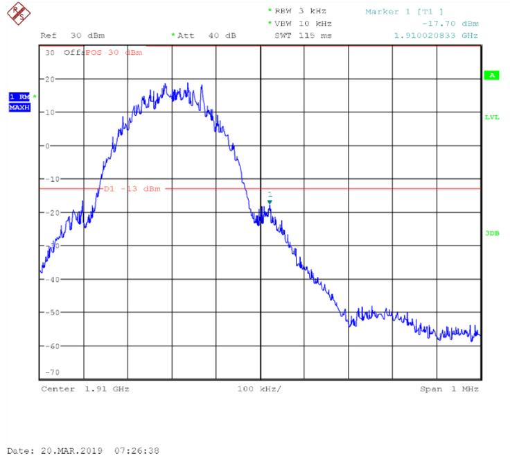
Fig.56 Channel 810- LOW BAND EDGE BLOCK
