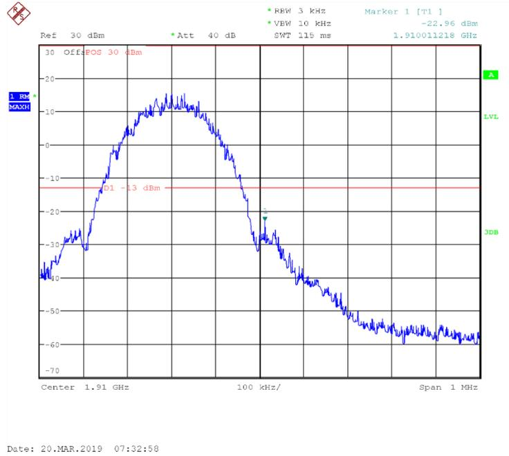
Fig.60 Channel 810- LOW BAND EDGE BLOCK
