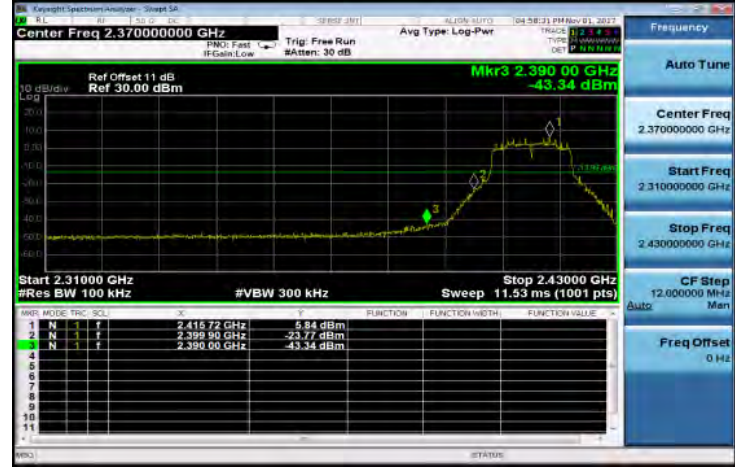
Band Edge Test Data CH-High
