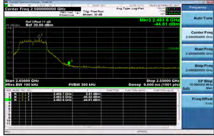
Band Edge Test Data CH-High
