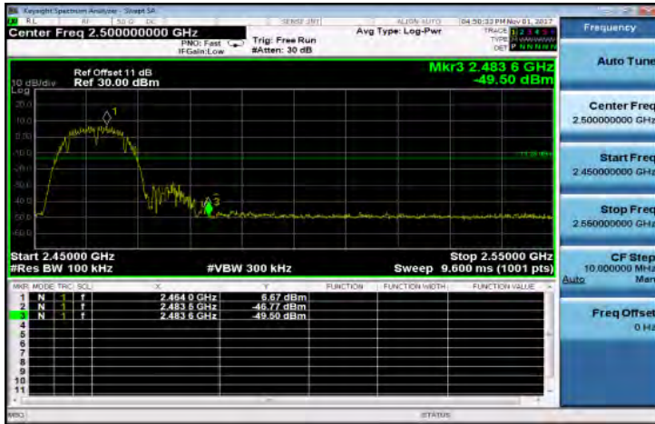
Band Edge Test Data CH-High
